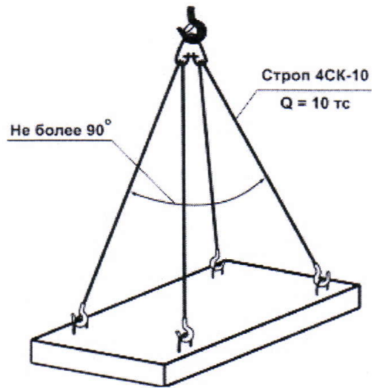
Рисунок Б.1 – Строповка плит перекрытия
